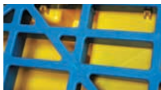
Plots de maintien des caillebotis prévenant la déformation des parois.
