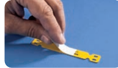
3) Scellez le porte-étiquette en appuyant d'un doigt sur le film et en poussant vers l'avant, de manière à le dérouler tout en décollant le support en silicone.
